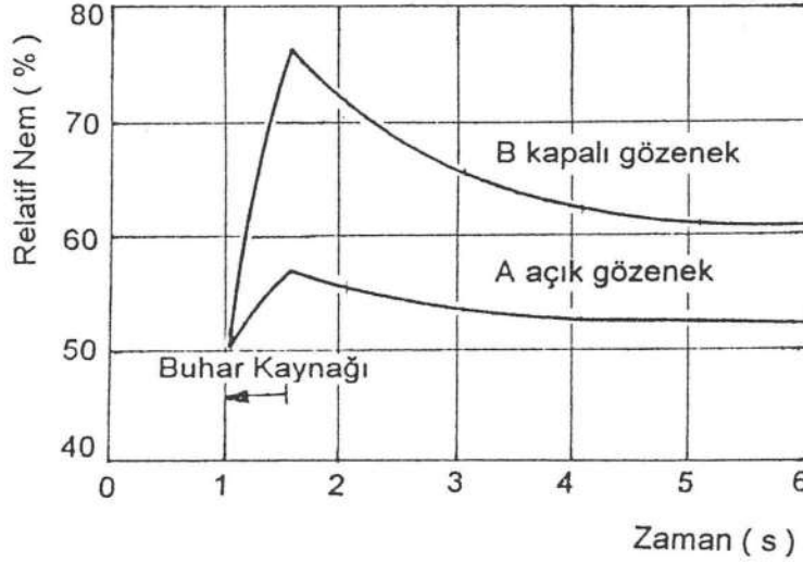
Şekil 3.9 Bağıl Nemin Duvar Yüzey Özelliğine Göre Değişmesi [39]
