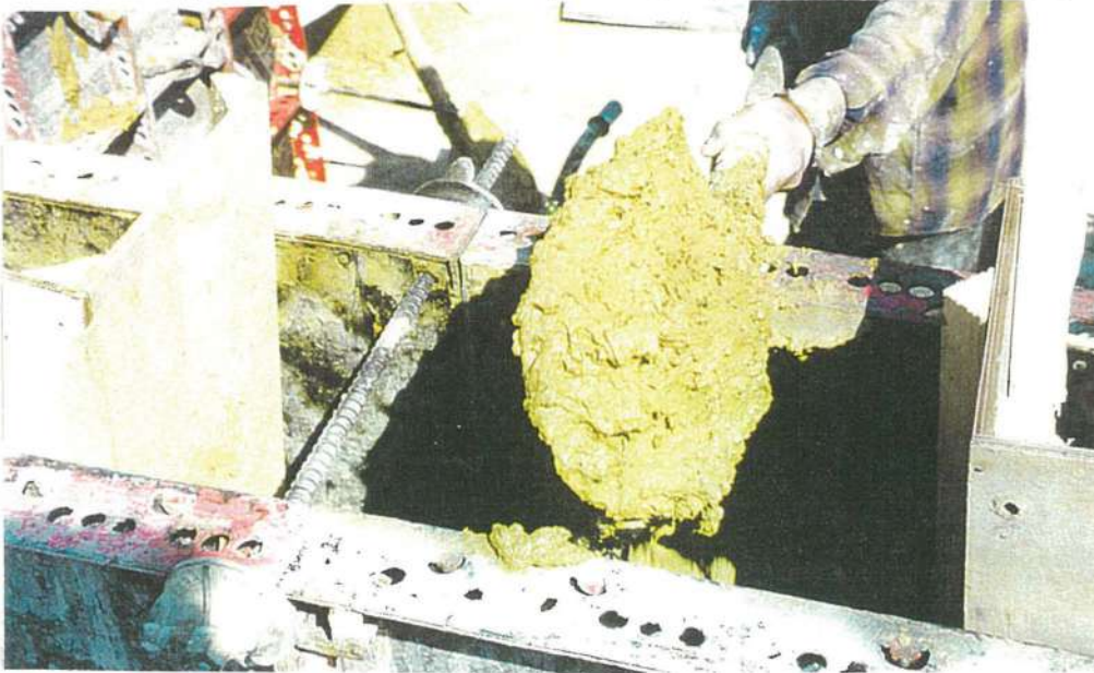
Resim 3.21 Kohesiv Karışımın İşlenebilme Güçlüğü
