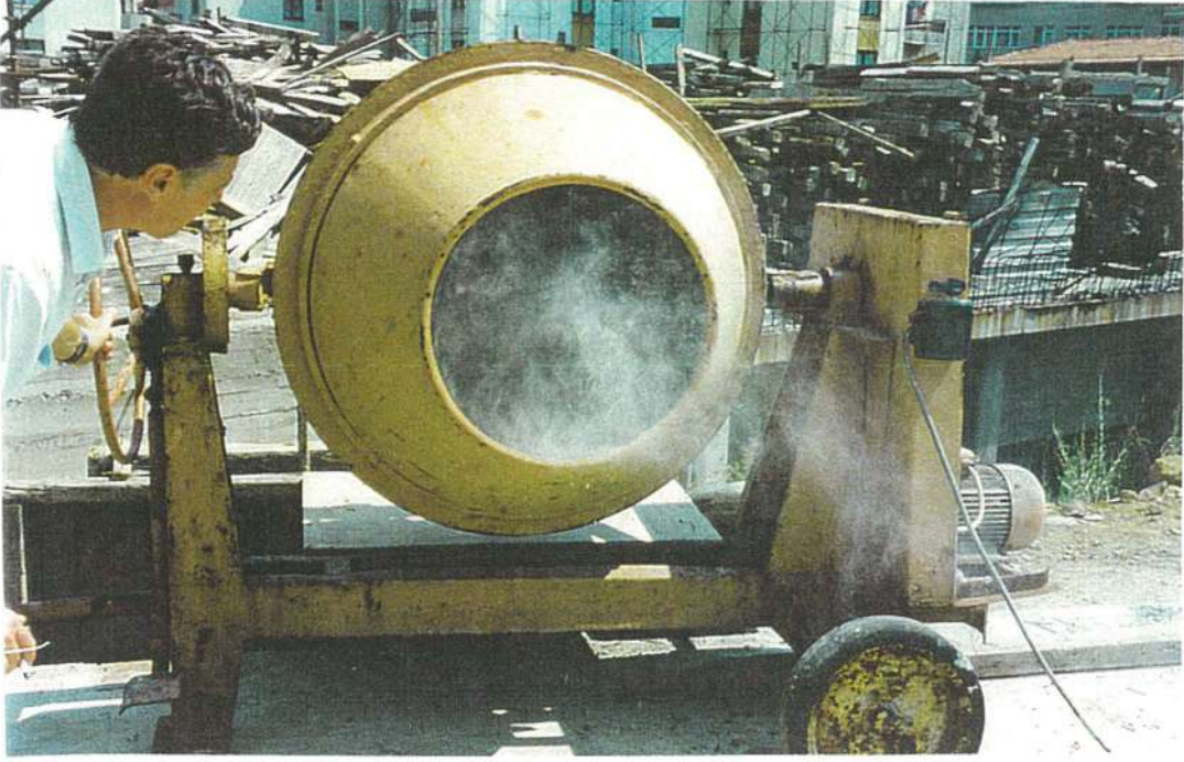
Resim 3.15 Kuru Alçının Kuru Toprakla Karışımı Sırasında Yaşanan Problemler
