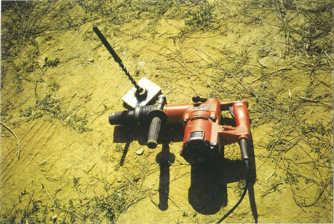
Resim 3.12 HILTI Ve Sıkıştırma İşlemi İçin İmal Edilmiş Özel Ucu
