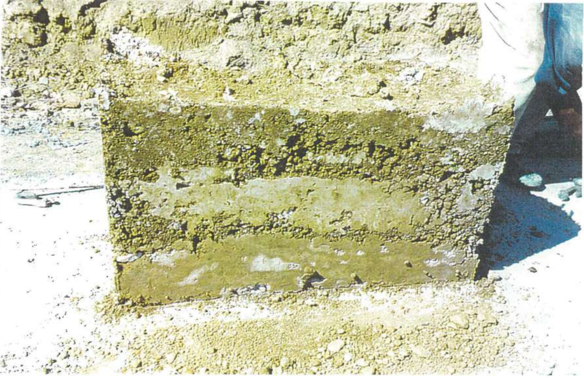
Resim 3 .17 Kuru Kıvamdaki Karışım İle Elde Edilen Kerpiç Numunesi
