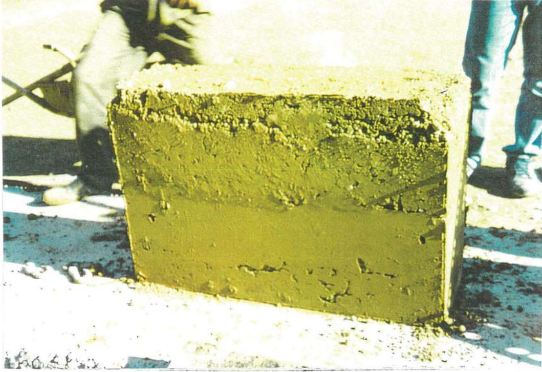
Resim 3.20 Bir Numune Üzerinde Farklı Zamanlarda Uygulanan Vibrasyon Sonucu
