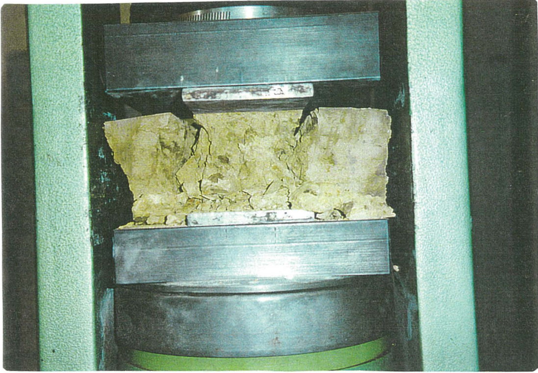
Resim 2.7. Basınç Presindeki Numune.
