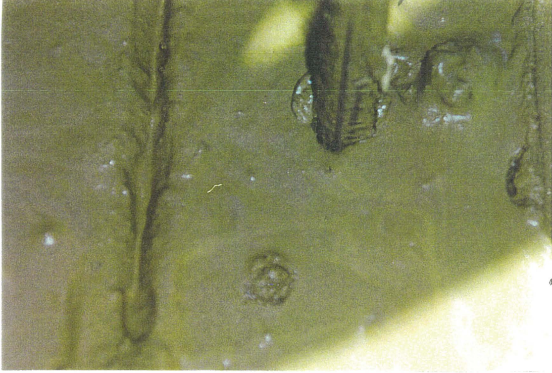
Resim 3.19 Likit Kıvamlı Karışımlarda Görülen Segregasyon
