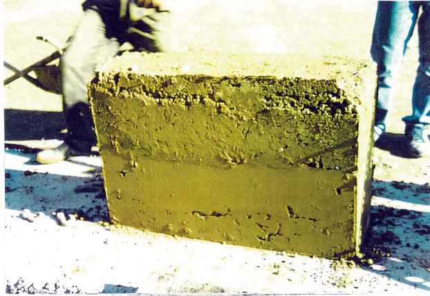
Resim 3.20. Bir Numune Üzerinde Farklı Zamanlarda Uygulanan Vibrasyon Sonucu
