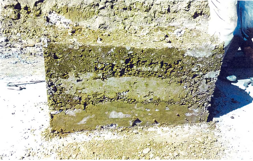
Resim 3.17. Kuru Kıvamdaki Karışım İle Elde Edilen Kerpiç Numunesi Picture 3.17. Adobe Sample Obtained with The Mixture at Dry Consistency
