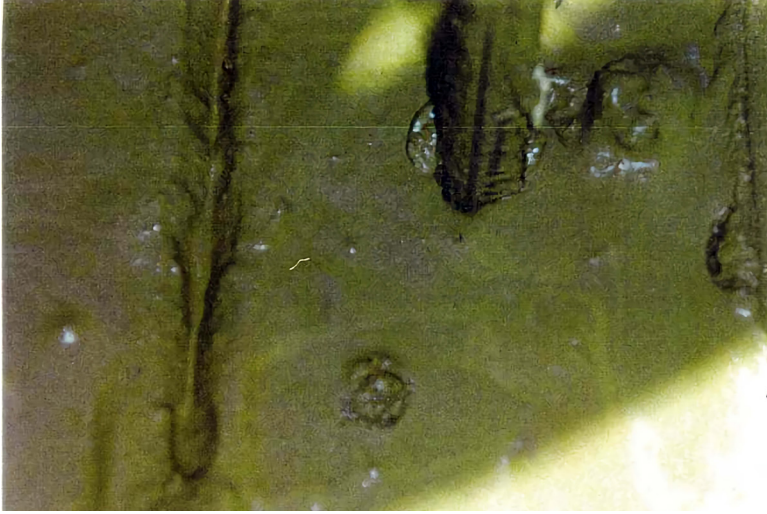
Resim 3.19. Likit Kıvamlı Karışımlarda Görülen Segregasyon Picture 3.19. Segregation Observed In Mixtures At Liquid Consistency
