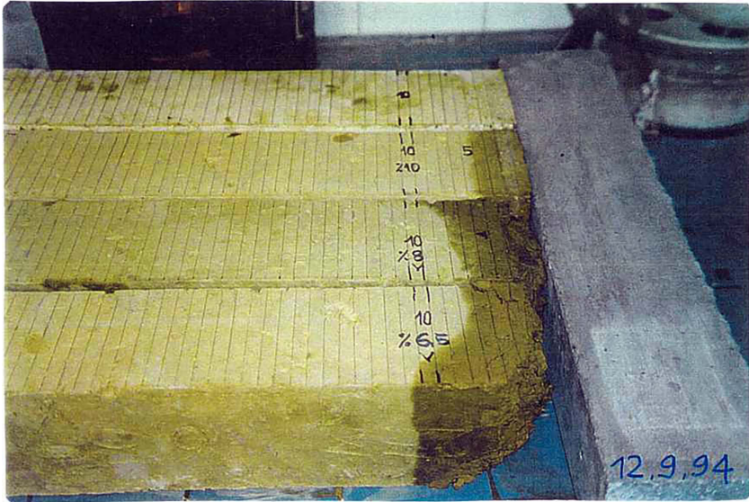
Resim 2.3. %10 Katkılı Alçı İle Hazırlanan Numunelerde 24 Saat Sonunda Suyun Yükselme Miktarları
