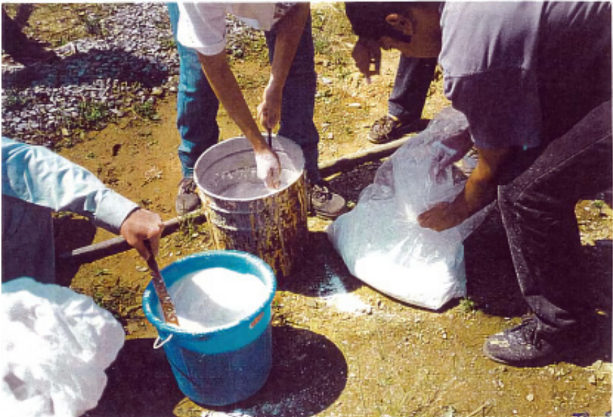
Resim 3.3. leklendirilmiř Kovalarda Ali + Kireli Su Karıřımının Hazırlanması Picture 3.3. Preparation of Gypsum + Lime + Water Mixture in Scale Buckets
